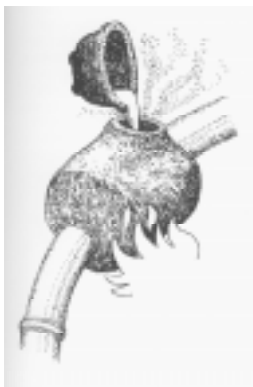
7. En lerform med indfyldningshul opbygges over vokssamlingen, der brændes væk. Hulrummet udstøbes med smeltet bronze
